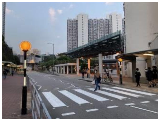
圖 4 香港葵青斑馬線新設 LED 燈連閃動白光的黃波交通燈的先導計劃，吸引駕駛者留意斑馬線行人橫越馬路( https://www.hk01.com/sns/article/762365 )
